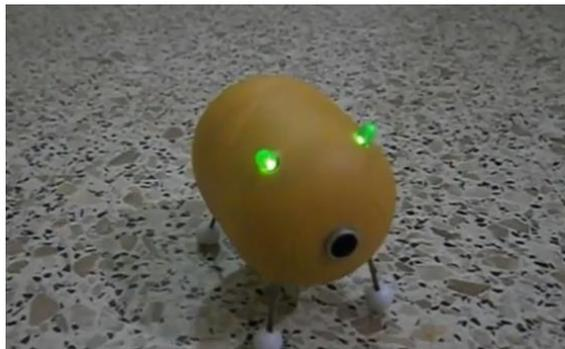
Рисунок 1. Робот, реагирующий на звук.
