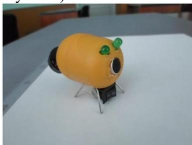
Рисунок 4. Собранная модель робота-аудиотропа.
